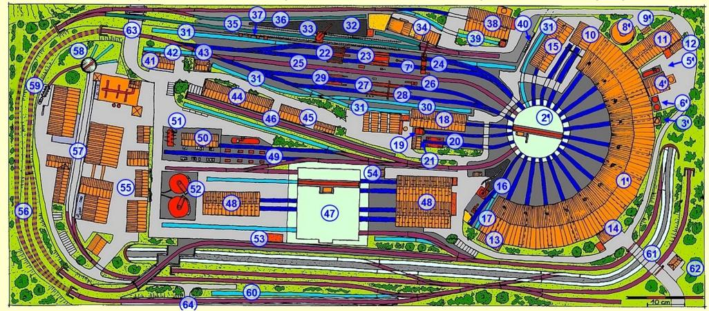
Die Sandbehandlungsanlage (34) besteht aus der Sandbevorratung (offene Lagerung), dem Sandbunker mit Trocknungsanlage (mit verschiebbarem Tonnendach) und dem Pumpen-/Drucklufthaus zur Beförderung des Sands mit Druckluft durch Druckleitungen zur Besandungsanlage.
